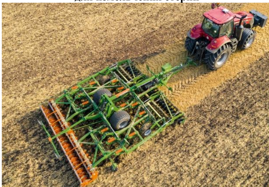
Рис.1. Комбинированный агрегат для обработки почвы с мульчированием: а)-агрегат Ceus 6000-2TX Super; б)-диски для измельчения стерни
