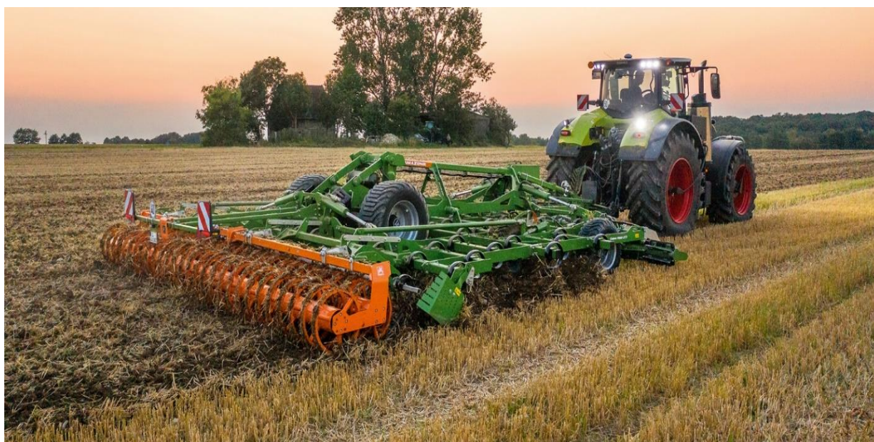
Рис. 4. Агрегат Собра в работе при обработке поля со стерней пшеницы
