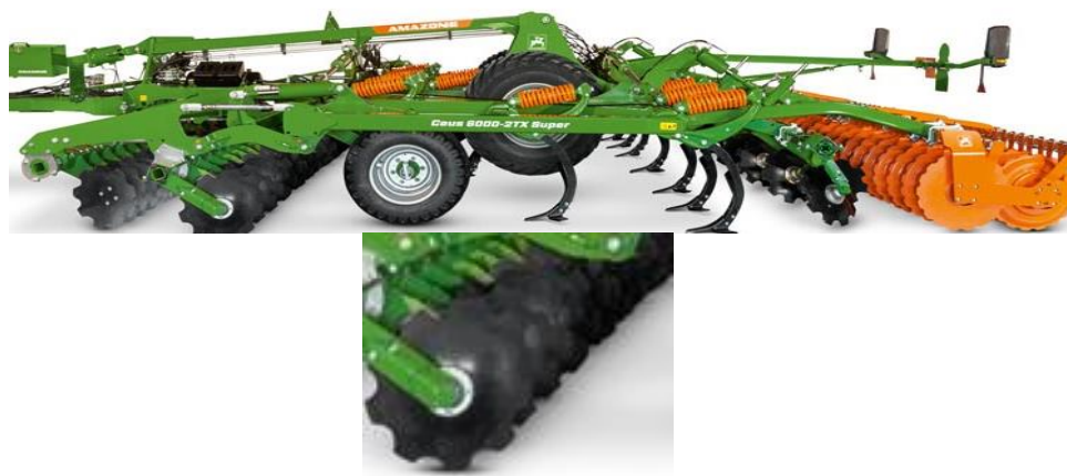
Рис.1. Комбинированный агрегат для обработки почвы с мульчированием: а)-агрегат Ceus 6000-2TX Super; б)-диски для измельчения стерни
