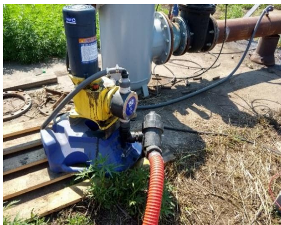
Рис.2. Дозатор для нормированной подачи КАС+S во «Фрегат»
