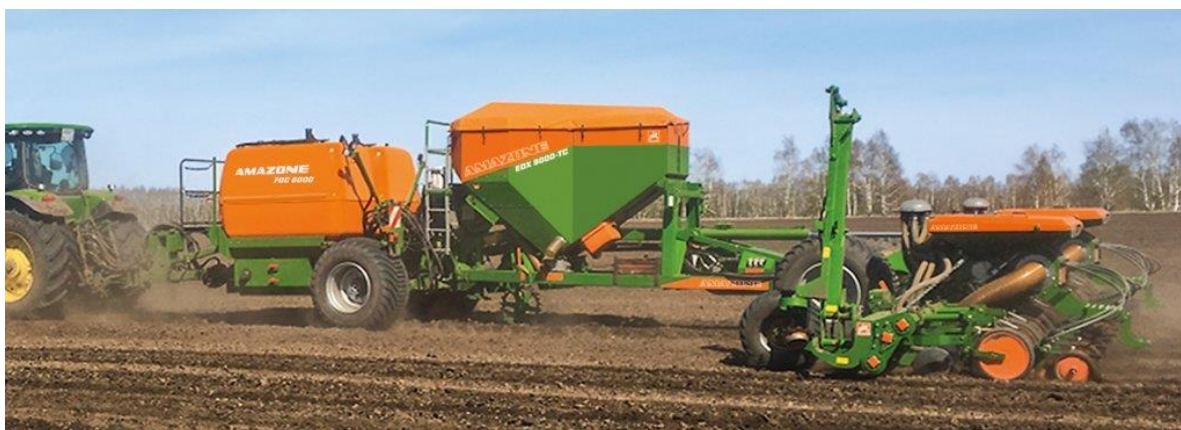
Рис. 2. Инновационный комплекс АО «Евротехника»: агрегат FDC-6000+ сеялка EDX-9000 (12000) для посева пропашных культур – подсолнечник, кукуруза с внесением жидких удобрений (в опытах Самарского ГАУ-КАС)
