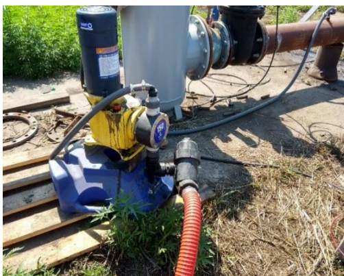
Рис.2. Дозатор для нормированной подачи КАС+S во «Фрегат»
