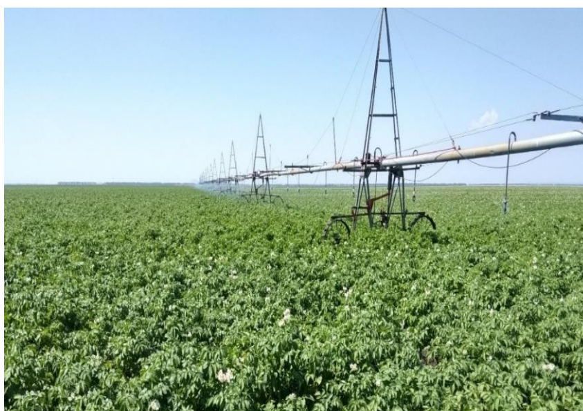
Рис. 1. Фрегат в технология подкормки сельхозкультур жидкими минеральными удобрениями КАС+S одновременно с поливом
