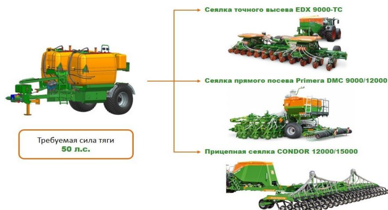
Рис.1. Агрегат FDC-6000 и его агрегатирование с сеялками АО «Евротехника»
